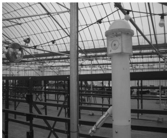
図表 14 土壌の状態を測定するフィールドサーバー
